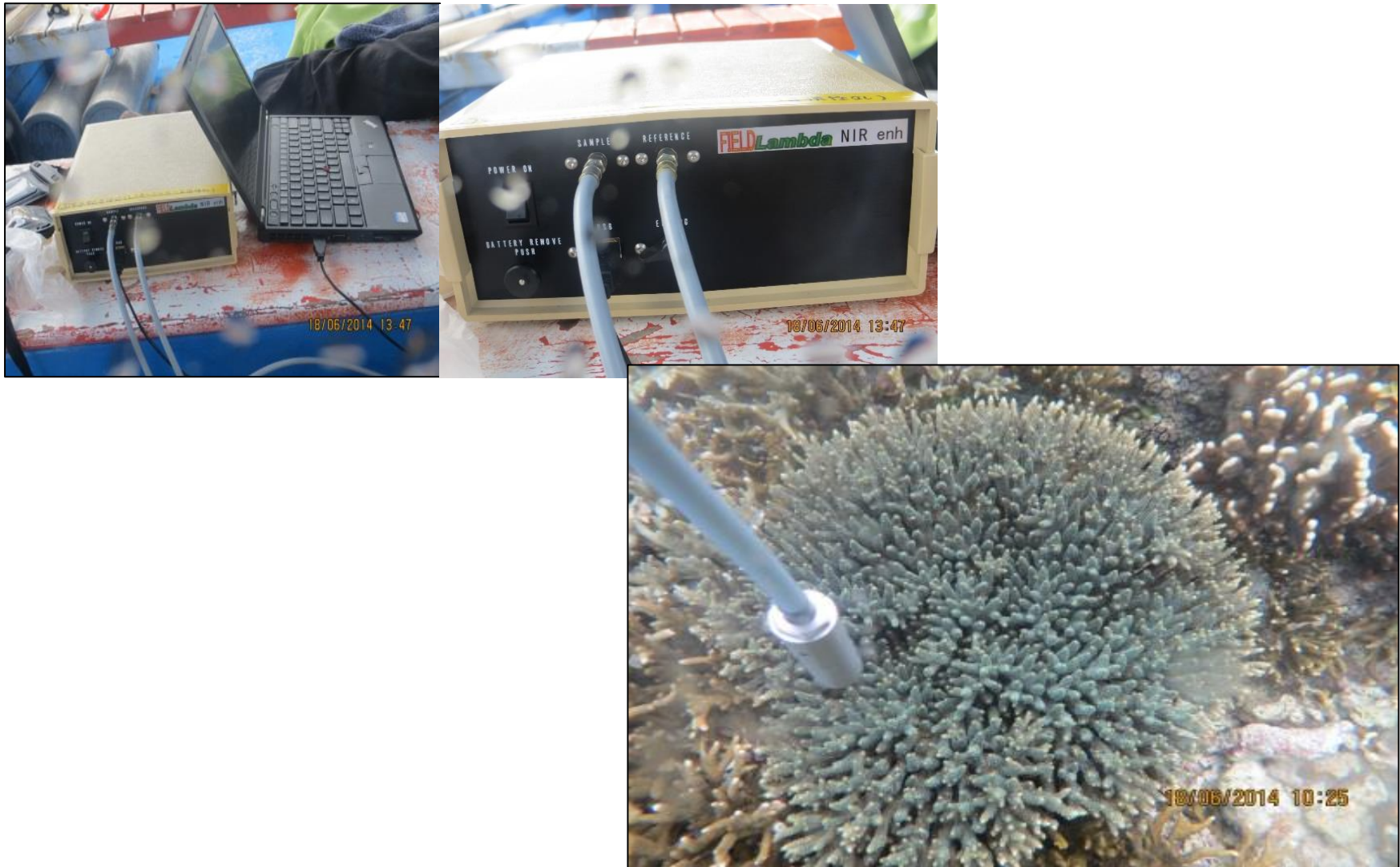
Gambar 2. Alat spectroradiometer underwater Field Lambda NIR enh yang digunakan untuk mengukur spectral karang massive
